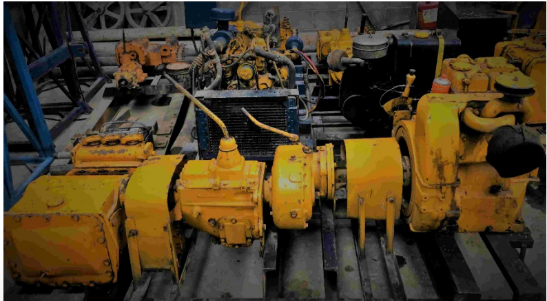
BOMBA DE LODOS BEANROYAL 535 y 420 (atrás)
